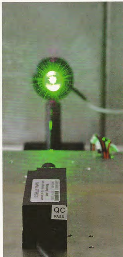
Obligatorischer Test: Hier wird die Leistung einer Laserdiode mittels Projektion auf den Leistungsmesskopf gemessen.
